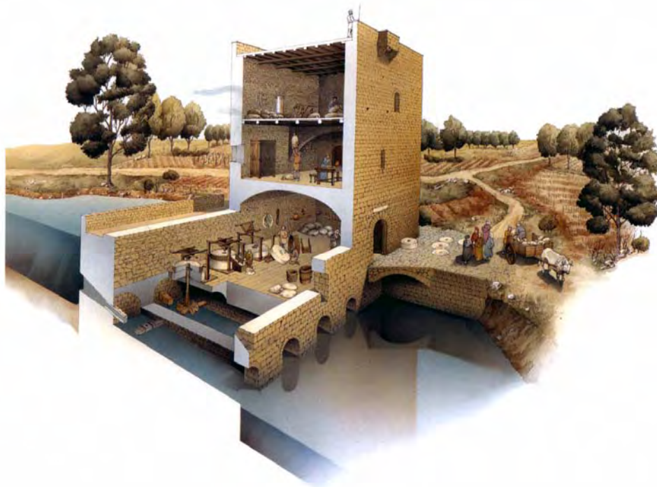
Ricostruzione del funzionamento dei grandi mulini fortificati della Val di Merse, dotati di numerose ruote idrauliche, coppie di macine e macchinari per la battitura della lana.
